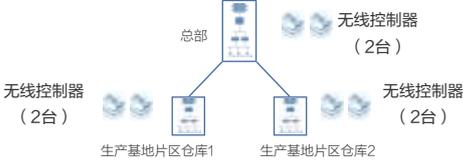
传统高可靠无线架构，需要每个机构2台AC，成本高，无总分灾备
