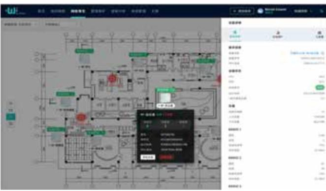
**无线全局地图式运维：**AP和地图联动，区域/楼栋/楼层，一键点击AP可查看周边信号质量和终端体验，快速定位质量问题
