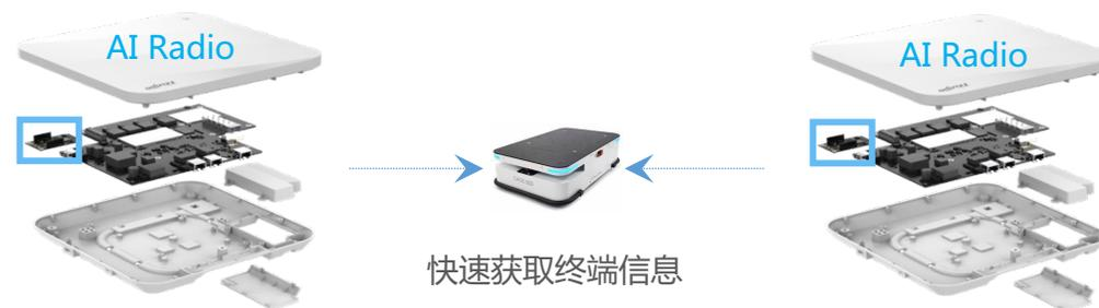
AR无线零漫游：基于AI Radio，主动探测终端信号情况，选择最佳AP引导终端无线漫游，达到“零漫游”效果，生产业务连续不中断
