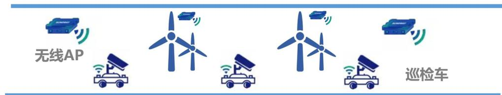
通过车载移动设备可覆盖场内道路，运检车辆和人员可利用该系统通过手机APP或者移动终端实时向主控室上报指令操作信息、回传工作中的标清或高清视频图像。
