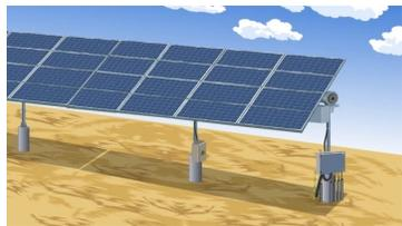
光伏板有高的达四五米，通信距离远，无线信号容易受干扰，光伏板阻隔会造成无线信号出现盲区等一系列问题。
