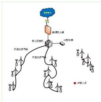
早期投建的风场，光纤及带宽资源不足，对光纤进行重新铺设、熔接工作，包括光缆地埋铺设、光缆熔接、损耗检测、安装调试，以及材料的运输，征地补偿等，投资大，周期长
